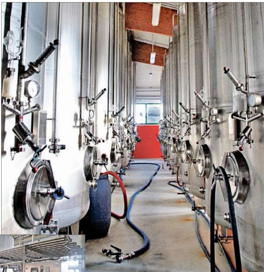
**Oben:** Das „Saftlager“ – in diesen Tanks wartet der gepresste Saft auf seine Abfüllung. **Links:** Damit der Saft in den Tanks gelagert werden kann, wird er in dieser Apparatur kurz erhitzt.
