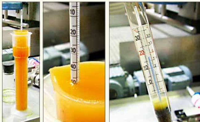
**Die Anwendung des Aräometers ist eine Dichtemessung: Dahinter steckt das Prinzip, dass Zuckerwasser eine höhere Dichte als ungesüßtes Wasser hat. Nullpunkt des Aräometers ist die Dichte von Wasser bei 20° Celsius. Je nach Zuckergehalt sinkt das Aräometer entsprechend tief ein und der Anteil des gelösten Zuckers in Grad Oechsle kann abgelesen werden. Hat der Saft eine andere Temperatur als 20° Celsius muss der Oechsle-Wert korrigiert werden.**
