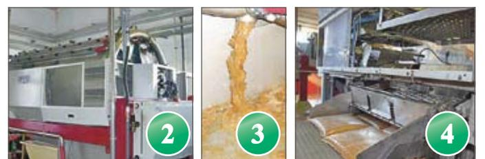
Die Apfelmaische wird in der Bucherpresse zu Apfelsaft gepresst, der dann in die Saftboxen-Beutel abgefüllt wird.
